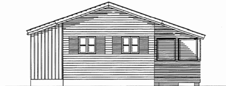
GAVLFASADE BAK: BOD, INNGLASSET VERANDA OG TAK OVER INNGANGSDØR
