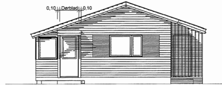
GAVLFASADE FRONT: BOD, INNGLASSET VERANDA OG TAK OVER INNGANGSDØR
